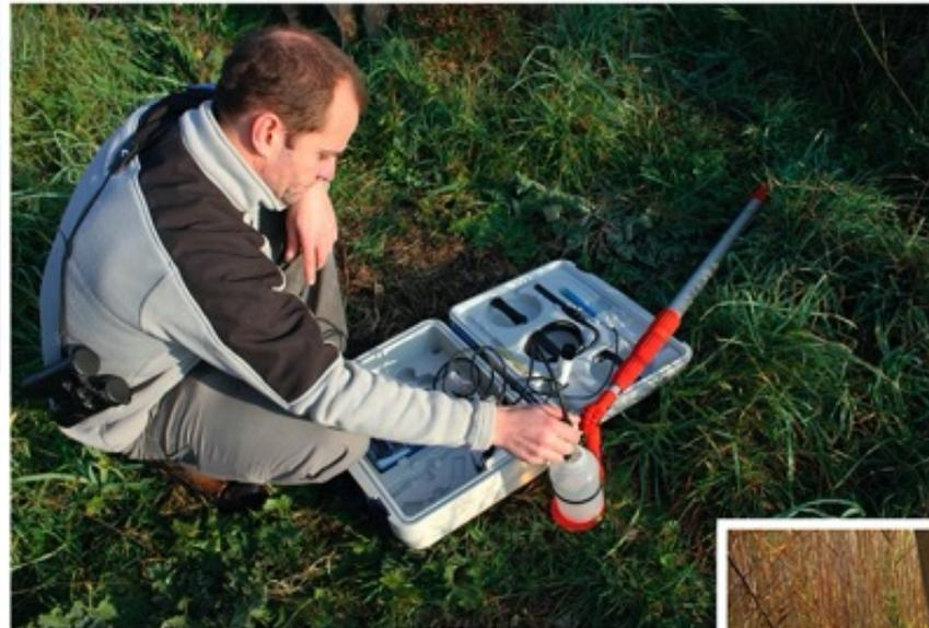
> A l'aide d'une sonde ou d'un boîtier multi-paramètres, on mesure des taux dans l'échantillon prélevé. On peut donc relever le pH, la température, la conductivité, la salinité ou encore l'oxygène... Les valeurs indiquées sur l'écran sont reportées sur un tableau. Ce dernier sera reporté sur un logiciel après les mesures de terrain afin d'être analysé.
